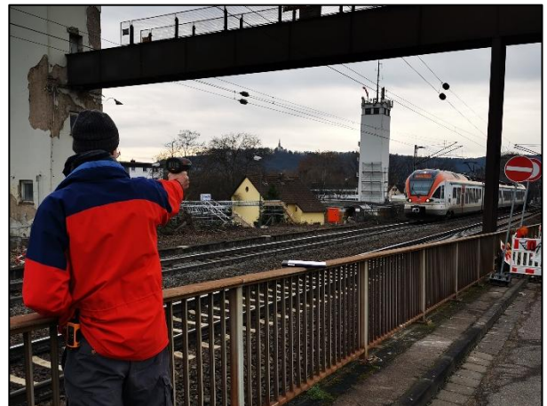
Abb. 4: Schwingungsmessgerät in Erdschürfe auf einem Erdanker Abb. 5: Geschwindigkeitsmessung vorbeifahrender Züge
