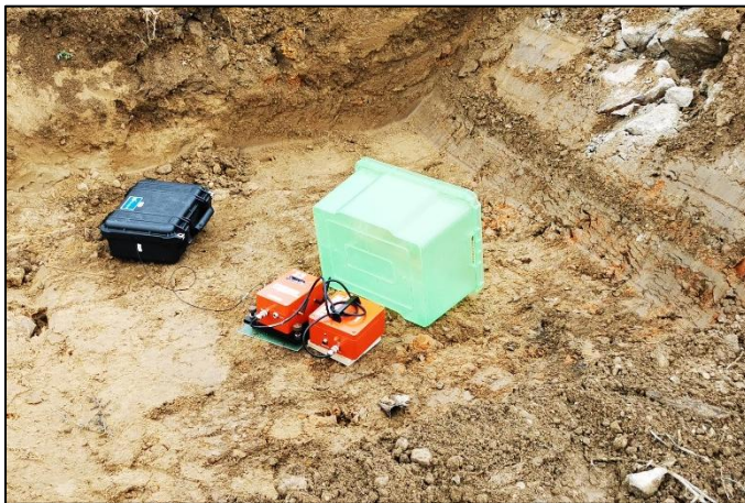
Abb. 4: Schwingungsmessgerät in Erdschürfe auf einem Erdanker Abb. 5: Geschwindigkeitsmessung vorbeifahrender Züge
